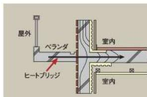
※ヒートブリッジ現象とは鉄やコンクリートなど熱を非常に伝えやすい材料が内部と外部でつながっている場合「ヒートブリッジ(熱橋)」となり熱が集中し流れる部位の事です。場所であればベランダになります。つまり夏は熱が、冬は冷気がベランダを伝わって室内の床に流れてきます。このヒートブリッジが結露の原因になり、また光熱費の浪費につながります。
